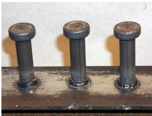
Obr. 3 Spřahovací trny
