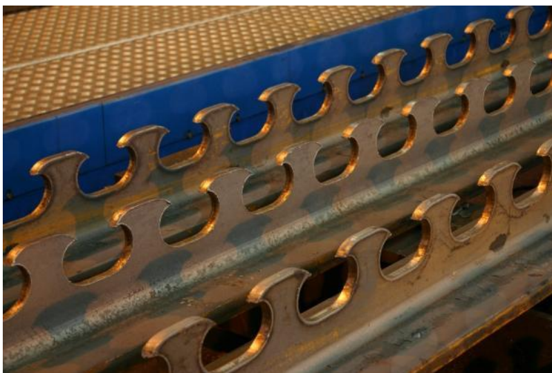
Obr. 5 Alternativní možnost tvaru spřahovací lišty
